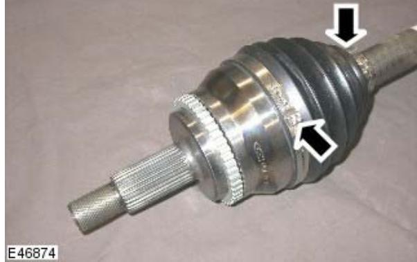
6. 沿着半轴滑动CV接头防尘罩, 以能进入球头。
